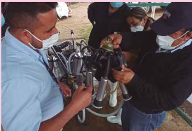
Revisión de vacío y pulsación en equipo MMU de ganadero de la Asoc. VIRGEN DEL CHACHO en Huacho como parte de la capacitación en diagnóstico de equipos dada por el Asesor Técnico MV Moisés Rojas.
