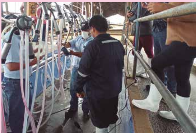
Revisión de vacío y pulsación en equipo de ordeño pendular de ganadero CIRILO RAMIREZ en Huacho como parte de la capacitación en diagnóstico de equipos dada por el Asesor Técnico MV Moisés Rojas.
