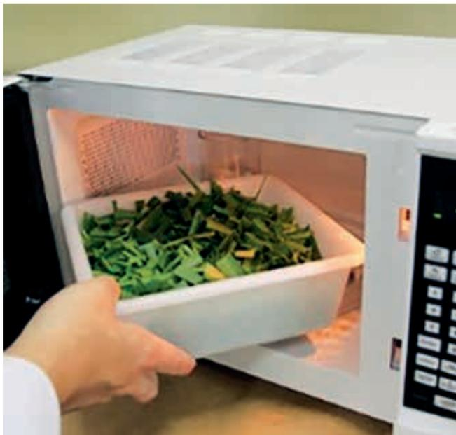
Figura 2. Determinación de la materia seca de la planta usando un horno de microondas. Es una metodología sencilla y requiere materiales de uso común como un microondas, balanza de cocina, vaso con agua y un recipiente plástico. Para mayores informaciones se recomienda el video de INIA (DETERMINACIÓN DE MATERIA SECA USANDO HORNO DE MICROONDAS -<https://youtu.be/dK0oZ1XXcvI>)
