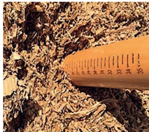
Determinación de la densidad del silo con un densímetro.
